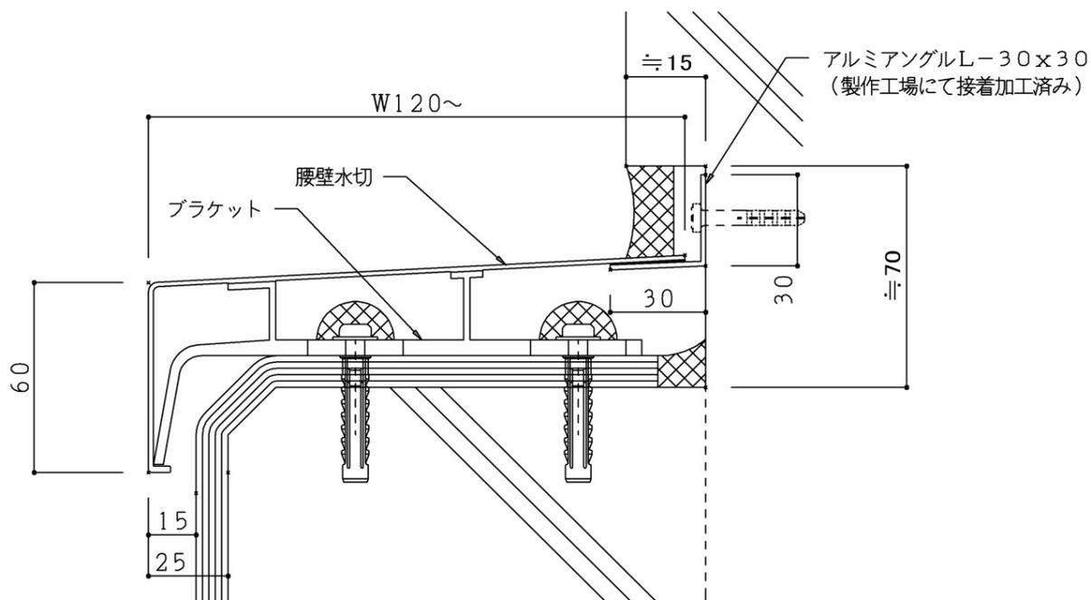
ブラケット取り付け完了後にアンカー部を必ずシーリングすること。
