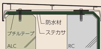
二重構造部の両側固定は、地震の際動きの異なる躯体に追従出来ず取付部品や躯体の損傷原因となります。
