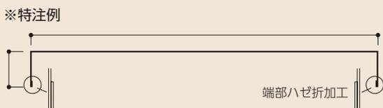
現場に合わせた寸法で特注サイズの製作も可能 既製品同様、ハゼ折加工いたします。
