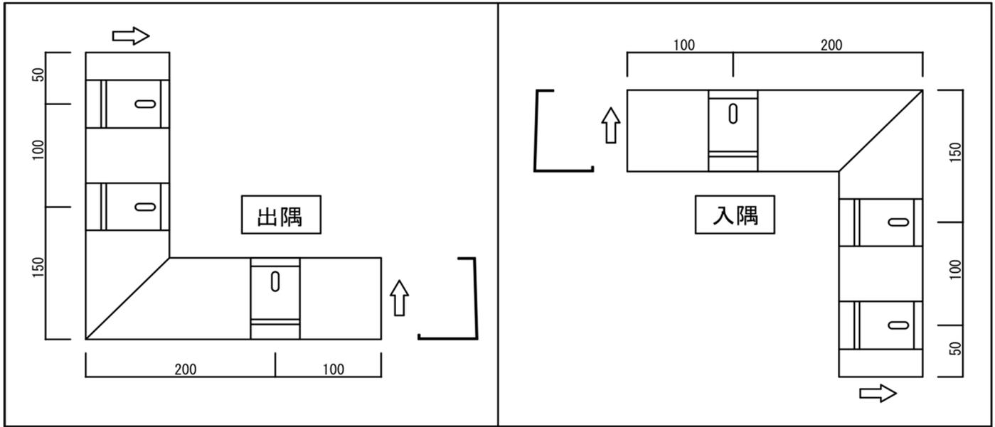
仕上面からアンカーまでの距離を50mm程度とするため前出しは12mmを目安として下さい。
