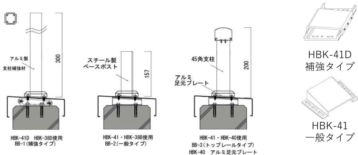
ベースブラケットタイプは一般タイプと高強度の補強タイプの2種、補強タイプは方立柱や控え柱を少なくしたい場合に有効です。
